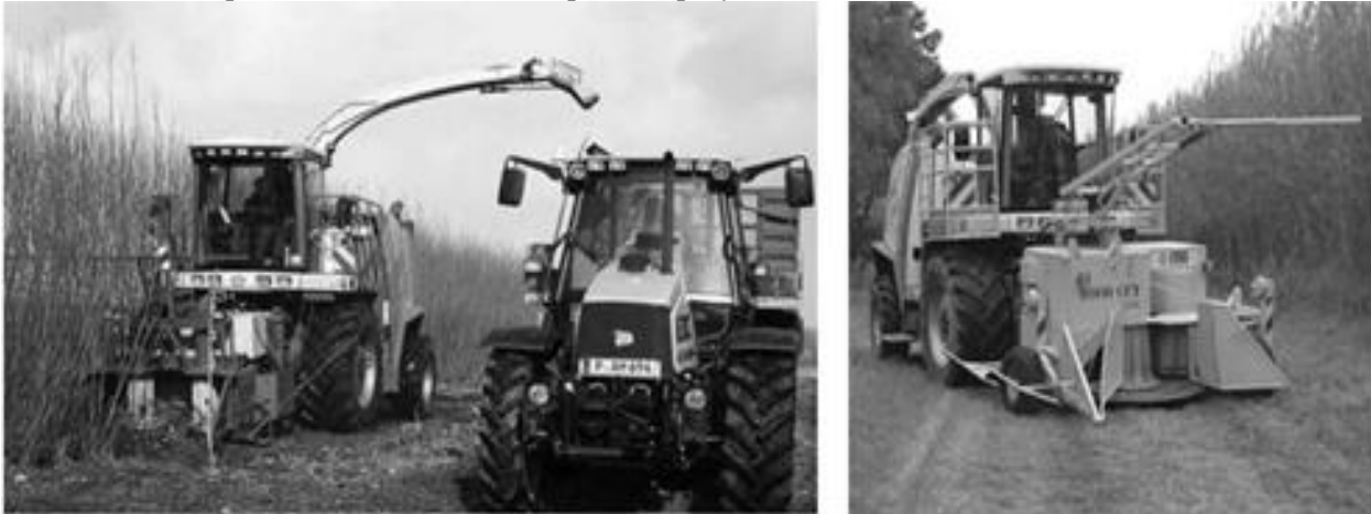
Рис. 3. Самохідна різальна машина Krone Big X із адаптером: а – Woodcut 750, б – Woodcut 1500
