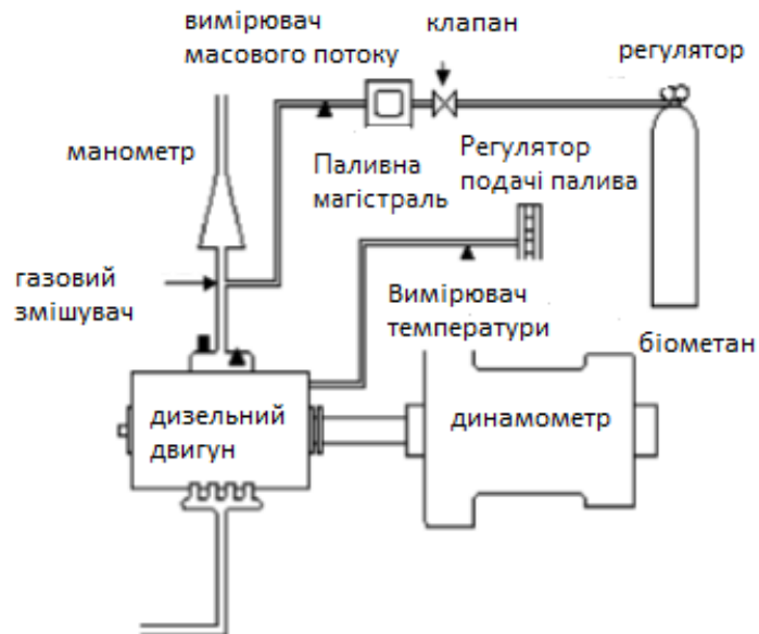
Рис. 2. Підключення газового устаткування
