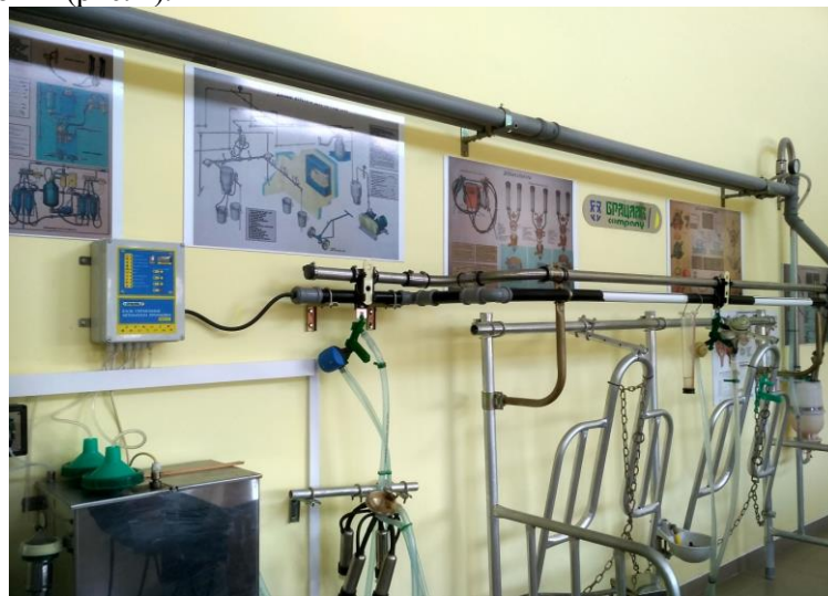
Рис. 1. Лабораторна модель системи промивки доїльної установки
