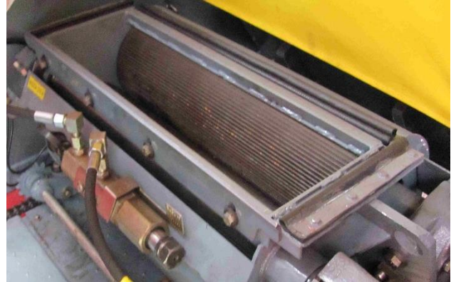
Рис. 2. Вигляд рифлених циліндричних вальців Палессе FS80-2
