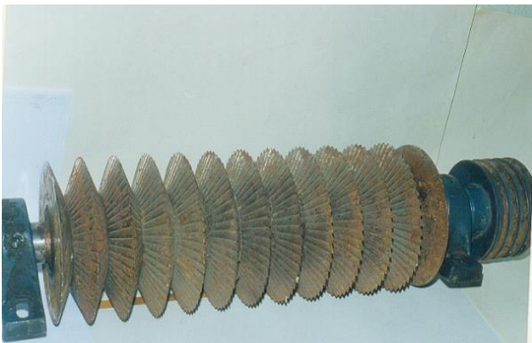
Рис. 3. Вигляд вальця набраного з рифлених конічних дисків
