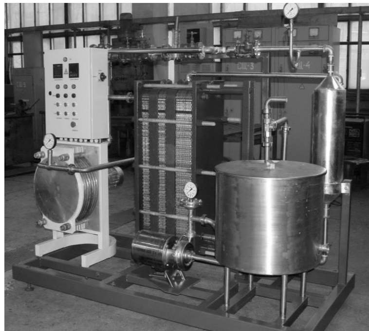
Рис. 3. Установка високотемпературної пастеризації вершків та жирних сумішей
