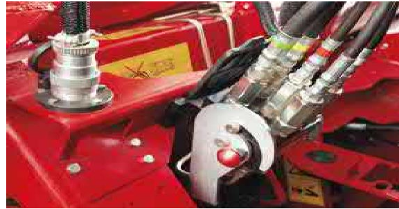
Рис. 10. 3'єднувальний механізм похилої камери
