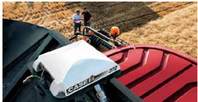
Рис. 17. Приймач AFS 372 GNSS
