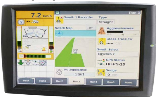
Рис. 16. Сенсорний монітор AFS® Pro
