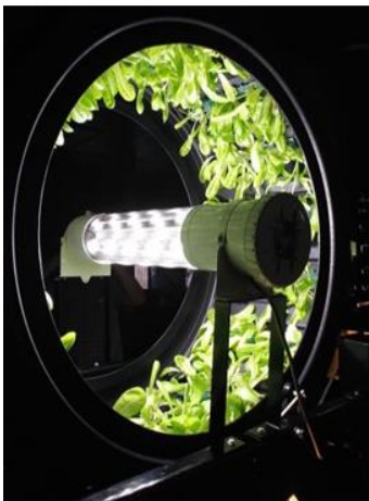
Рис. 5 Схеми поворотної гідропонної системи
