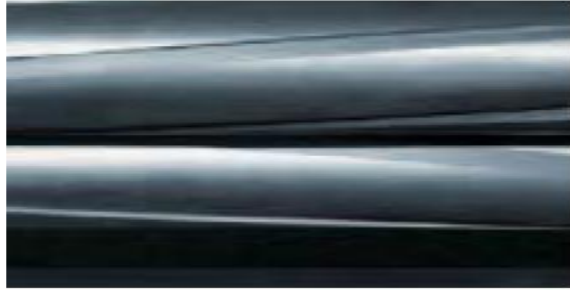
Рис. 3. Спіральні вальці із збільшеною шириною впадин
