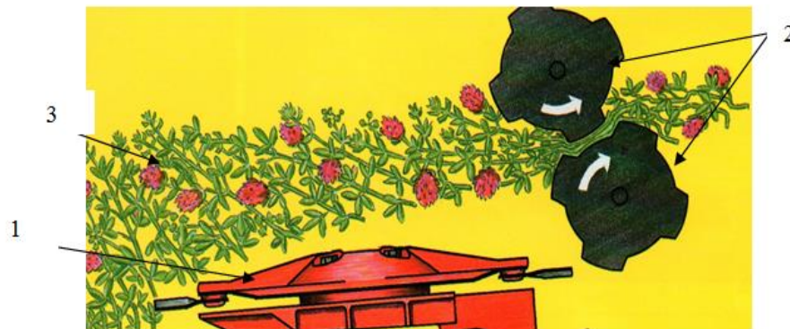
Рис. 1. Схема роботи вальцьового плющильного апарата: 1 – різальний апарат; 2 – плющильні вальці; 3 – рослинна маса.
